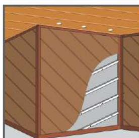
Pasang **DUMA® PANEL** dalam keadaan menyilang dengan rangka. Pemasangan dilakukan secara berurutan dari salah satu ujung ke ujung yang lainnya dengan sekrup kepala datar.
