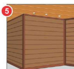
Pasang Lis Profil dengan lem PVC & **paku tembak** setelah seluruh area plafon atau dinding tertutup dengan **DUMA® PANEL**.
